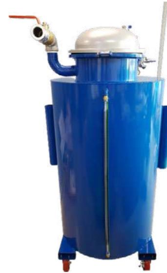
수용성의 절삭유를 칩 클리너를 이용하여 Air로 흡입하면 칩만 망에 걸러지고 이물질이 없는 깨끗한 수용성 절삭유로 재사용할 수 있습니다. 가공 장비 내에 칩과 절삭유를 1~2 개월에 1회씩 청소 및 칩을 걸러줌으로써, 절삭유의 교체 주기를 연장하여 원가절감이 되며, 가공 장비 내의 절삭유가 부패하는 것을 방지하여 작업장 내의 환경도 개선됩니다.
